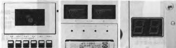
カンカローポケット式カセット装置。ステレオレベルメーター内蔵。コイン枚数2桁表示。
