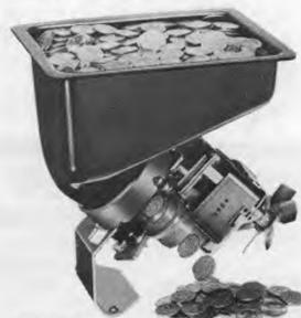
英国コインコントロール社と旭精工が永年の技術と経験から作りあげた最も小型で確実な機構に最大の収納容量をもつミニホッパー
