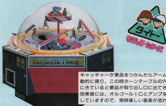
キャッチャーが景品をつかんだらアームが自動的に戻り、この時ターンテーブルの穴が下にきていると景品が取り出し口に出ます。効果音には、オルゴールICとアンプを内蔵していますので、常時楽しい音楽が流れます。
