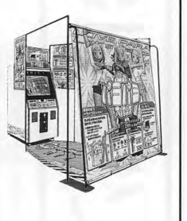
恋のバラバラ大作戦 TVダンスゲーム。カメラでプレイヤーの動きをとらえ、手本どおり踊っているかをチェックしゲームで評価する。自社ロケ用。【ナムコ】No.616
