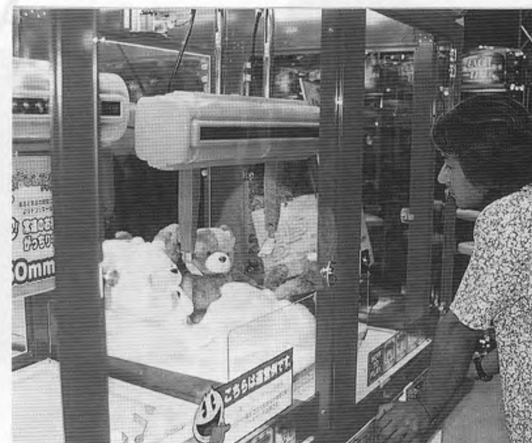
左は幅55センチの間隔がある二本の爪を使用したナムコの新タイプ「新型クレーンゲーム」(仮称)
