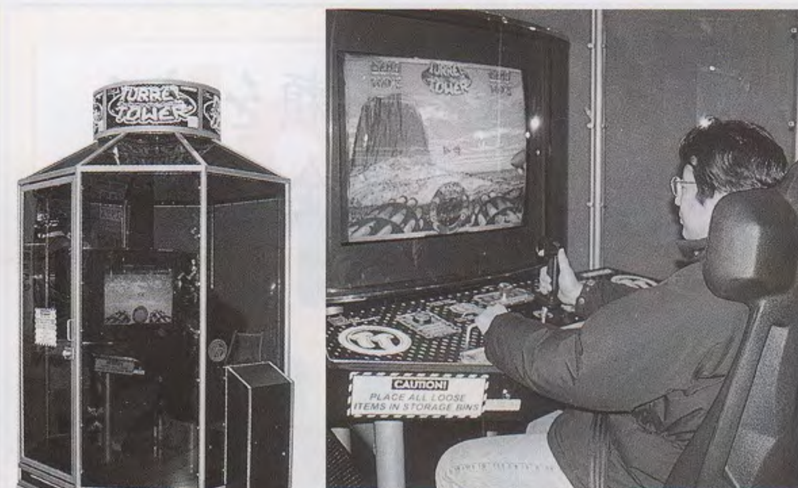
写真はナムコアメリカ社の「タレットタワー」で左は外観、上は内部で操作している様子。円形テーブル上にキャビネットと座席が設置され、全体が操作方向によって水平回転する体感ゲーム
